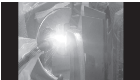
図3、原子炉1次冷却水系内ステンレス板の完全除染2MBq/kgを検出限界以下まで除染
